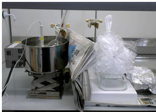
写真2 氷嚢を用いた冷却法
