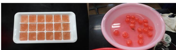
3. 膜の強度はメスフラスコに水を入れていき、力をかけ、破裂した瞬間に電子天秤に表示されている数値を動画で撮影し、記録した。
